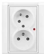
zásuvka dvojnásobná s natočenou vrchní dutinou, s clonkami, s ochranou před přepětím, s optickou signalizací poruchy
