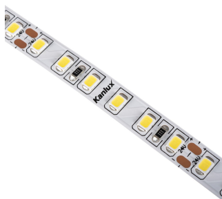
KANLUX Pásek LED SMD studená bílá 16W/m 1920lm/m 24V 6000K IP00 5m ELFETEX kód: 11.419.651 Kód výrobce: 33313
