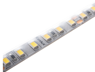
KANLUX Pásek LED SMD studená bílá 16W/m 270lm/m 24V 6000K IP65 5m ELFETEX kód: 11.419.654 Kód výrobce: 33316
