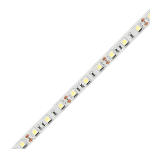
MCLED Pásek LED SMD teplá bílá 14,4W/m 1152lm/m 12V 3000K IP20 5m ELFETEX kód: 10.920.181 Kód výrobce: ML-121.600.60.0
